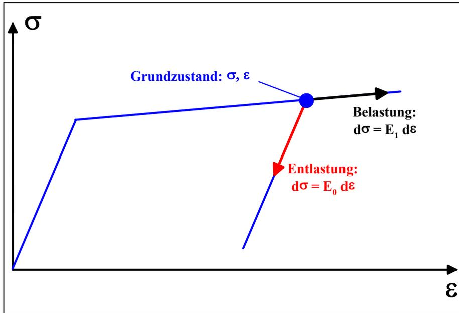
Nichtlineare Materialgesetze lassen sich i. d. R. nur *inkrementell* formulieren. Je nach Verzerrungszinkrement *verzweigt* das Gesetz in *unterschiedliche Pfade*. Somit ist es nur möglich, mittels eines *tangentialen Materialtensors* ein *Verzerrungszinkrement* mit einem *Spannungszinkrement* zu verknüpfen.
